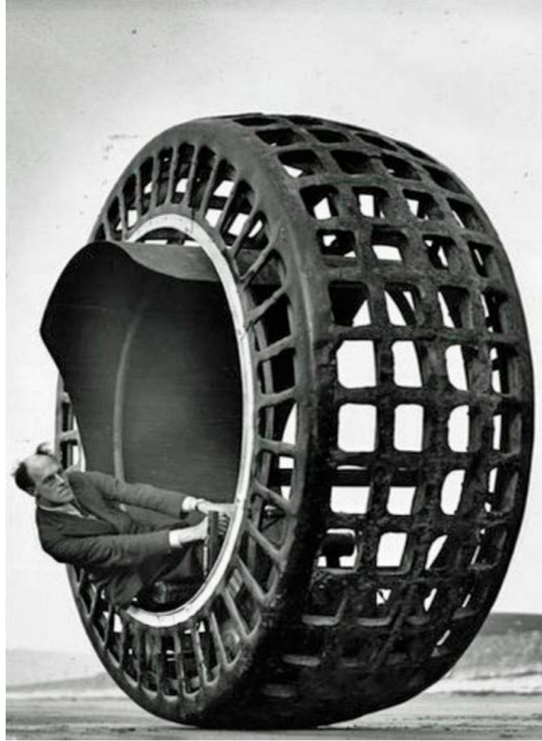
Dynasphere foi um veículo patenteado em 1930 por John Archibald; atingiu 40 km por hora
